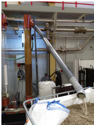
Figur 6. Test av elektrokoaguleringsanläggning vid Stormossens avvattningsstation. Foto: Mikael Åbacka, Axolot
